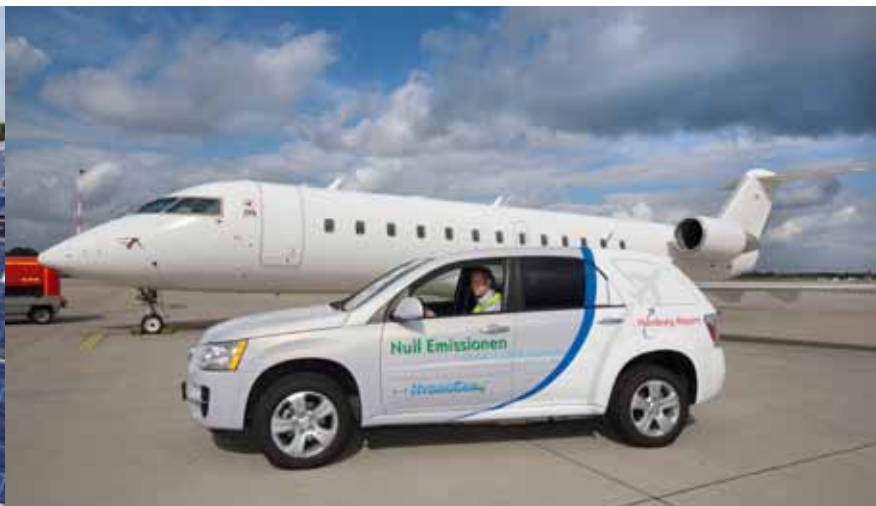
Opel Hydrogen4 mit 93-kW-PEM-Brennstoffzellenantrieb
