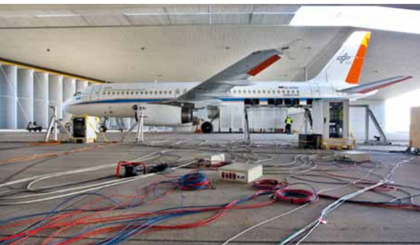
Fluglärnforschung des DLR (Deutsches Zentrum für Luft- und Raumfahrt) für leisere Flugzeugtriebwerke in der Lärmschutzhalle am Hamburg Airport
