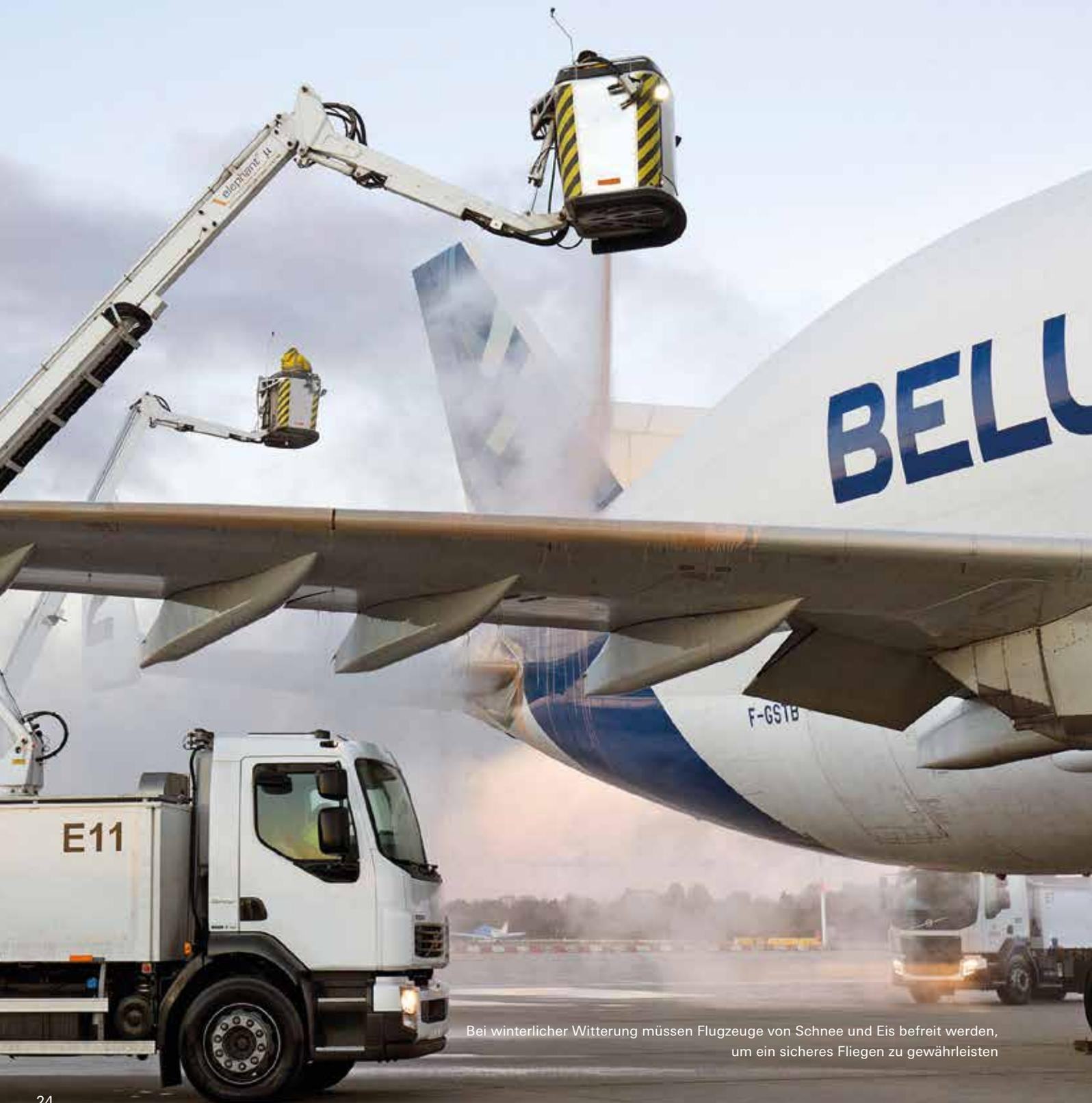
Bei winterlicher Witterung müssen Flugzeuge von Schnee und Eis befreit werden, um ein sicheres Fliegen zu gewährleisten
