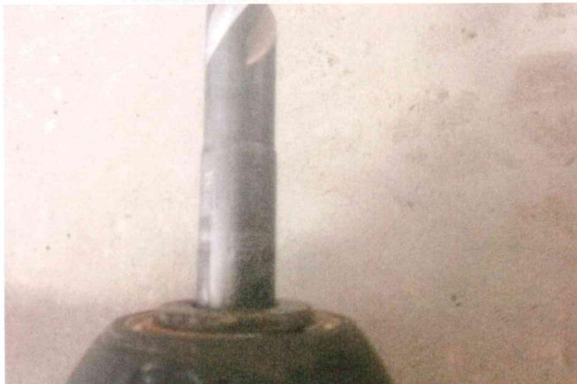
10mm Bohrer/ Einbautiefenmarkierung 70mm
